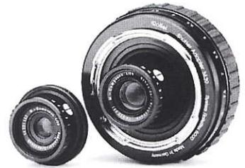
Mit Hilfe eines kleinen Adapterringes (im Lieferumfang) von M39 auf M40 lassen sich Imagon-Objektive der Brennweiten 150 und 120 mm (Normalfassung) verwenden. Um  $\infty$  zu erreichen, müssen beim Imagon 150 zusätzlich die Zwischenringe 9 + 34 mm verwendet werden. Beim Imagon 120 mm ist der Zwischenring 9 mm erforderlich.
