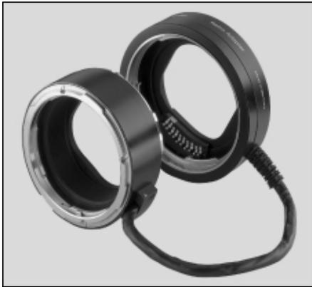
Durch den **Retroadapter** erweitert sich der Anwendungsbereich der Rolleiflex 6008 AF/6008 integral2 im Nahbereich. Dieser Adapter ermöglicht die sinnvolle Retrostellung aller Objektive der Filterbajonettgröße VI unter Beibehaltung aller Belichtungsmess- und Belichtungsfunktionen. Es ist vorteilhaft, den Retroadapter mit dem Balgengerät zu verwenden. Dabei ergibt sich z. B. mit dem Planar 2,8/80 mm in Retrostellung ein Abbildungsmaßstab von 1,8:1 bis 3,5:1.
