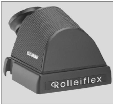
Der **Prismensucher** mit 45° oder der **Fernrohrsucher** mit 90° Einblick liefern ein seitenrichtiges und aufrecht stehendes Sucherbild. Sie rasten in vier jeweils um 90° gedrehte Stellungen ein und bieten dadurch bequemen Einblick auch bei ungünstigen Aufnahmepositionen. Beim Aufsetzen dieser Sucher auf die Kamera wird die Display-Anzeige automatisch umgestellt, damit sie seitenrichtig erscheint.
