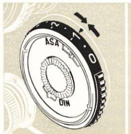
In Ausnahmefällen (Blitzlicht, hohe Filterwerte über -3) berücksichtigt man den Filterwert bei der Belichtung dadurch, daß für jeden vollen Wert eine um 3 DIN verringerte Filmempfindlichkeit zugrunde gelegt wird.
