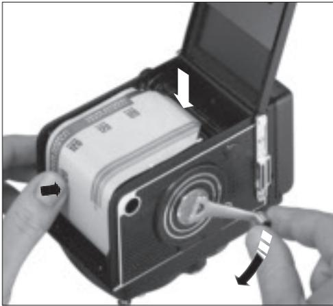
Anfang des Schutzpapiers in den langen Schlitz der Leerspule (mit Kurbel 32 entsprechend einstellen) tief einstecken. Film mit der Kurbel straff aufspulen (untere Spule mit dem Daumen bremsen), bis die Pfeilmarkierung auf dem Schutzpapier mit dem roten Index am Kamerakörper zur Deckung gebracht wird.
