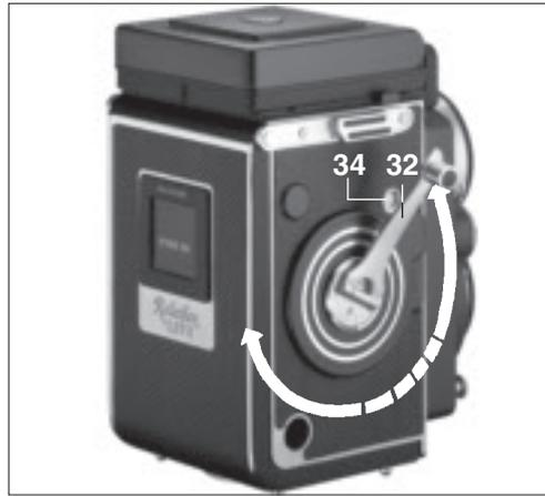
Filmtransport auf Bild Nr. 1: Kurbel 32 zügig bis zum Anschlag drehen und in Gegenrichtung zurück bis zur Ausgangsstellung. Die Kurbel ist jetzt in ihrer Ausgangsstellung blockiert. Das Bildzählwerk 34 zeigt das 1. Bild an, der Verschluss ist gespannt, der Film ist bereit zur ersten Aufnahme.
