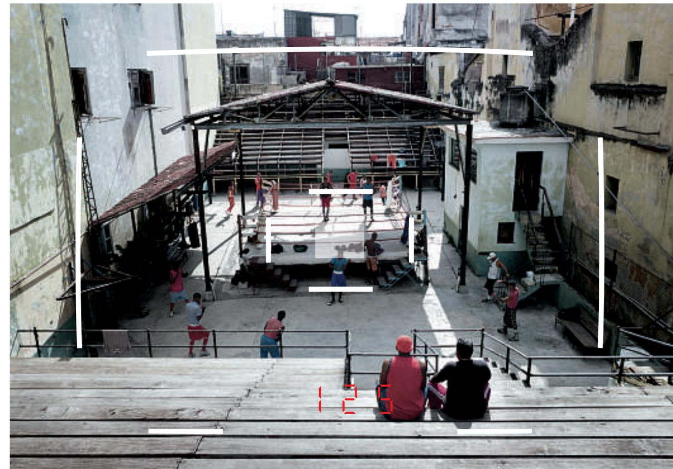
Blick durch den Sucher einer M-Kamera: Der äußere Leuchtrahmen zeigt hier den Bildausschnitt für 28 mm Brennweite an, der innere Rahmen zeigt den Bildausschnitt für 90 mm an. In der Bildmitte ist das Messfeld zu sehen, über das fokussiert wird.
