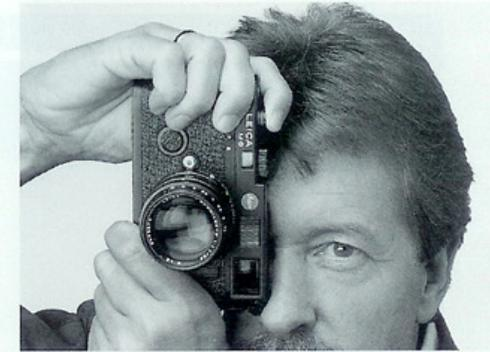
Für Hochformataufnahmen wird die LEICA nur gedreht. Die Hände bleiben in der gleichen Stellung wie bei Aufnahmen im Querformat. Die LEICA kann aber auch nach unten geschwenkt werden. In diesem Fall löst der Daumen den Verschuß aus.
