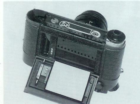
zur Hälfte in den hierfür vorgesehenen Raum der Kamera einstecken, den Filmanfang fassen und bis in den Aufwickeldorn hinein ziehen (siehe schematische Darstellung auf dem Kameraboden). Wird der Filmanfang zu weit herausgezogen, so daß er aus einem der Schlitzlöcher auf der gegenüber liegenden Seite des Aufwickeldorns ein wenig herausragt, stört das nicht die Funktion.
