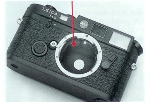
schicht aufgetragen werden kann, ohne die Funktion des Verschlusses zu beeinträchtigen. Die ungleichmäßige Struktur des Meßflecks beeinträchtigt das Belichtungsergebnis in keiner Weise. Die Silizium-Fotodiode mit vorgesetzter Sammellinse ist oberhalb des Verschlusses links untergebracht. Die für die Belichtung richtige Zeit-/Blendenkombination wird mit Hilfe einer im Sucher sichtbaren Lichtwaage (▶◀) ermittelt: beide LED's leuchten bei richtiger Belichtung gleichzeitig und gleich hell.
