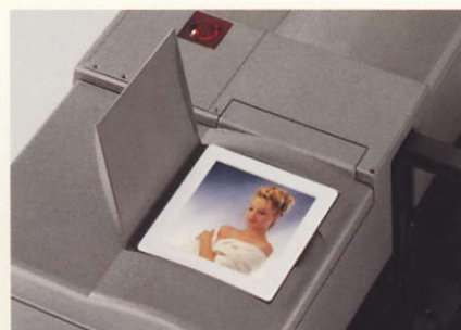
Schnelle und bequeme Dia-Vorsortierung am Monitorfenster auf der Gehäuseoberseite.
